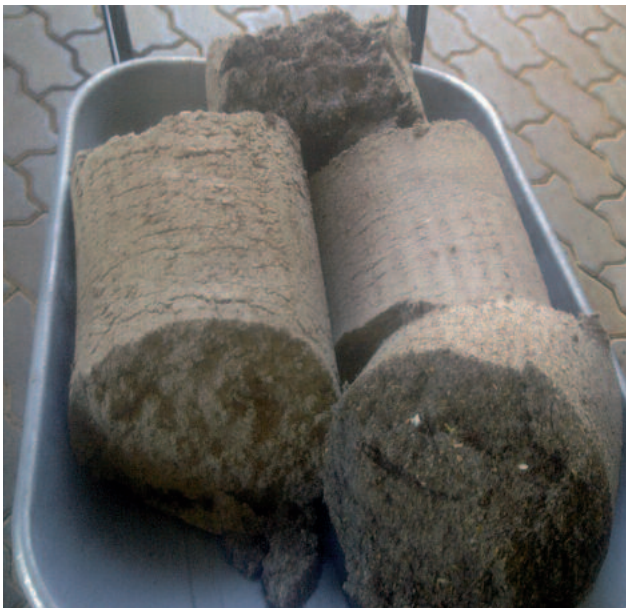
Kuivattu välpe WAP-neste laitteesta, joka on asennettu mesh välpän jälkeen, jonka aukot ovat 0.3 mm
