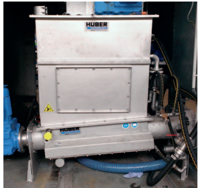
WAP-neste, jossa vaihdettavissa oleva rei'itetty pohjalevy, jonka aukot ovat 0.75 / 1 / 1.5 mm
