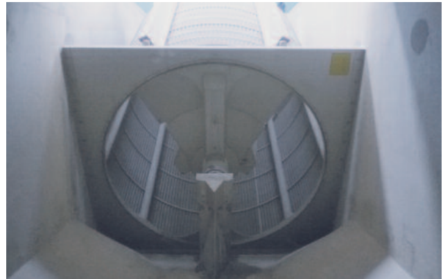
RPPS Tähti neste välpän rakenne, jossa seulana taitettu reikälevy antaa jopa 30% suuremman kapasiteetin. Reikäkoot 1 / 1.5 / 2 mm.
