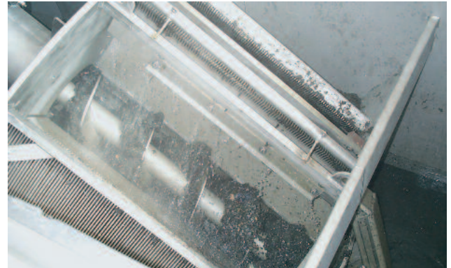
Kelluva ja leijuva aines jää seulakoriin. Haravan piikit ylettyvät korin rakoihin ja pitävät seulakorin automaattisesti puhtaana
