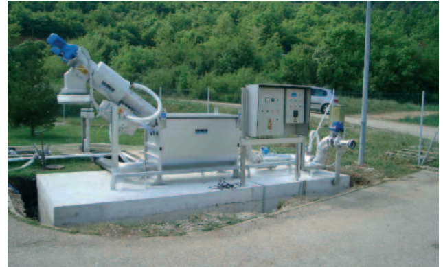
ROTAMAT® Ro3.1 Sakokaivolietteen vastaanotto-asemaan on yhdistetty erinomaisiksi todettuja esikäsittelylaitteekomponentteja
