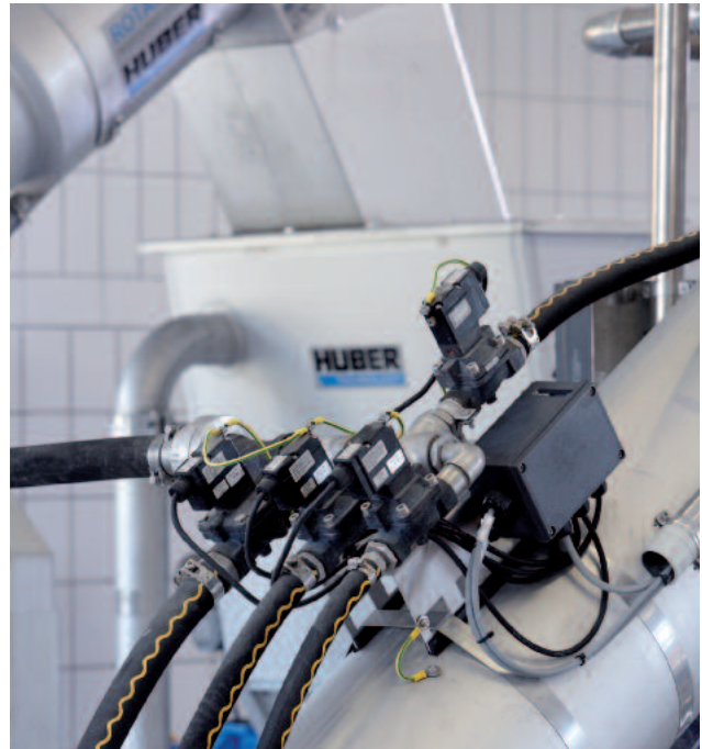
ROTAMAT® Hienovälppä pyörivällä seulakorilla, jossa sisäänrakennettu välppenpesuri IRGA.
