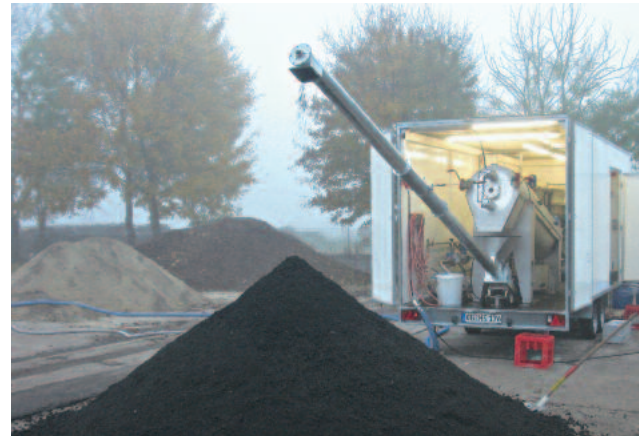
Sopimuskuivaus trailerille asennetun HUBER Ruuvikuivaimen Q-PRESS® avulla
