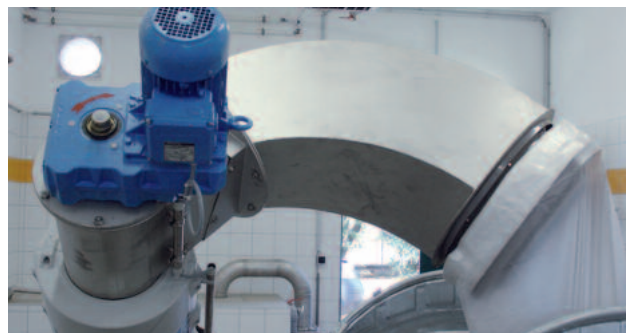
Индивидуально адаптированная установка с отводящей трубой для выгрузки отходов непосредственно в контейнер
