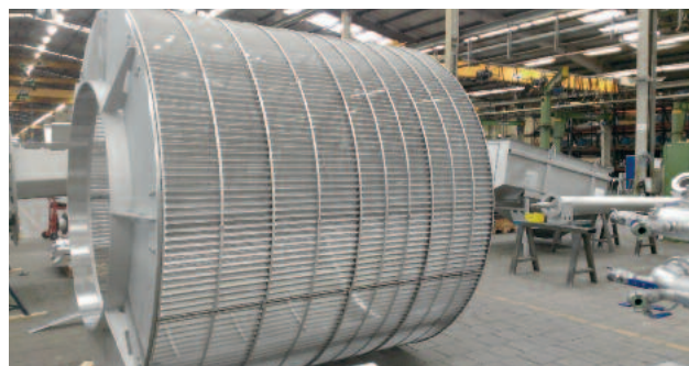
Барабанная решетка ROTAMAT® STAR, диаметр 2600 мм, перфорация 1 мм, обработанная кислотой в ванне травления и пассивированная
