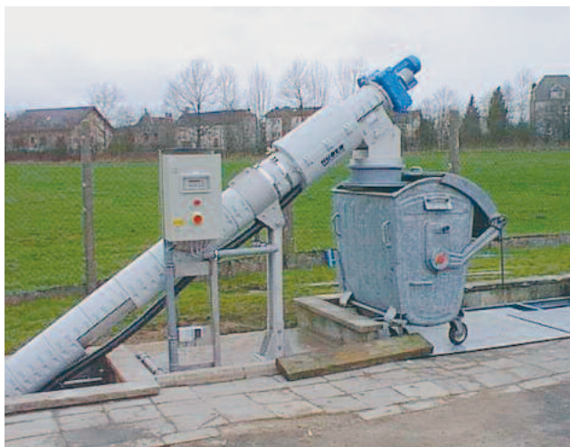
Наружная морозостойкая инсталляция барабанной решетки с вращающейся гребенкой HUBER ROTAMAT® Ro1
