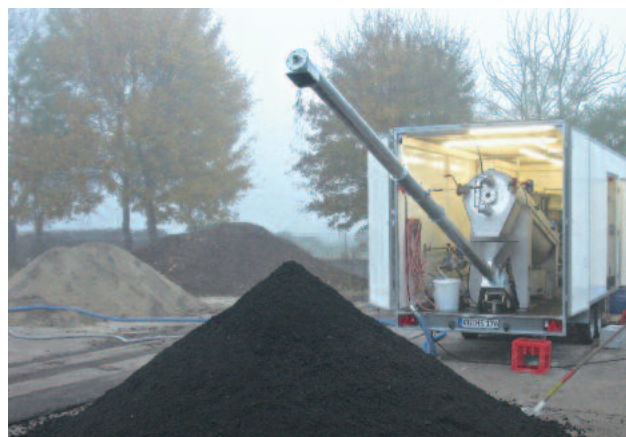
Обезвоживание, осуществляемое по договору, с помощью HUBER Q-PRESS®, установленного на прицепе
