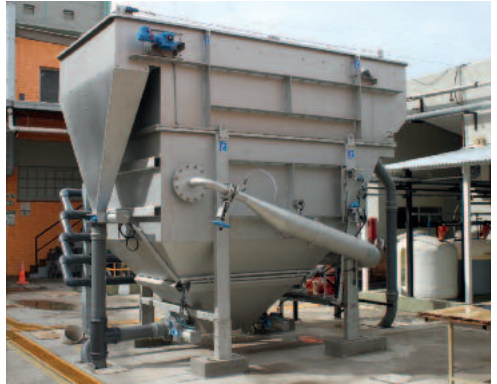
Flotáció a zsír- és szilárdanyag leválasztásához a halfeldolgozásban
