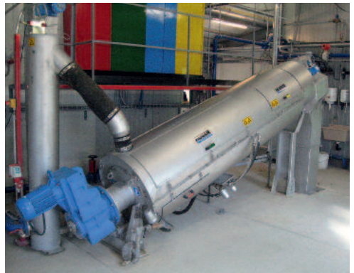
HUBER Csigaprés S-PRESS: specifikus teljesítményszükséglet: < 0,01 kWh/kg TR
