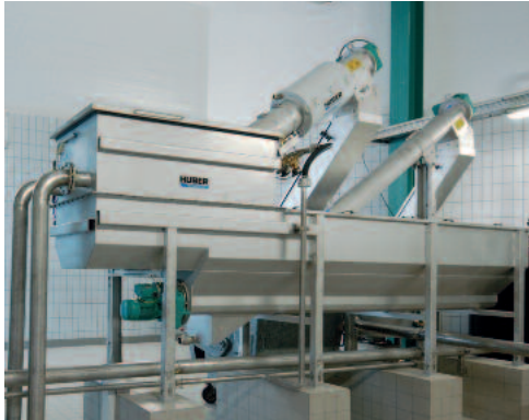
HUBER Fekália fogadóállomás ROTAMAT® Ro3.3: egy világszerte bevált berendezés
