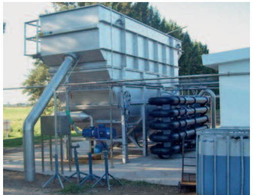
Zsírleválasztás a tejiparban nyomáscsökkentő flotációval
