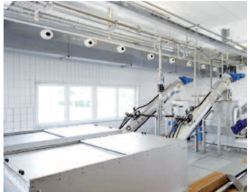
HUBER Szűrőberendezés ROTAMAT®Ro 2, lehetséges szűrőkosárátmére: 3 m-ig
