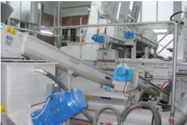
Monimutkaiset ratkaisut, jossa ruuvit syöttävät seuraavaa ruuvia eivät ole ongelma..
