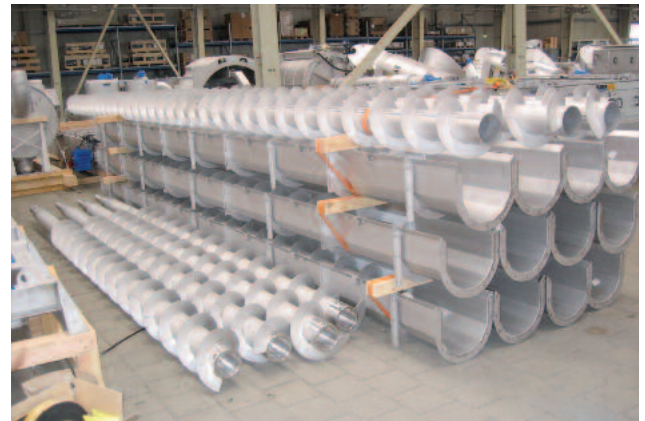
Ruuvikuljettimien valmistus HUBERin tehtaalla.
