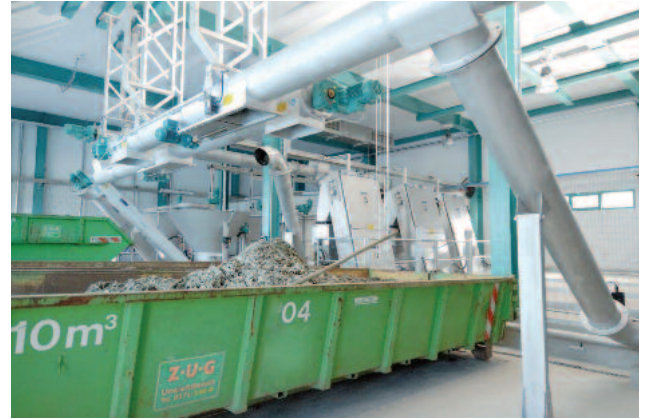
HUBER ROTAMAT® Ruuvikuljetin Ro8 kuljettaa välpettä
