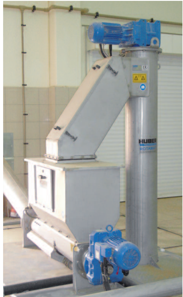
Pystyasennossa oleva ruuvikuljetin nostaa välpeet ja purkaa HUBER WAP välpepesuriin.
