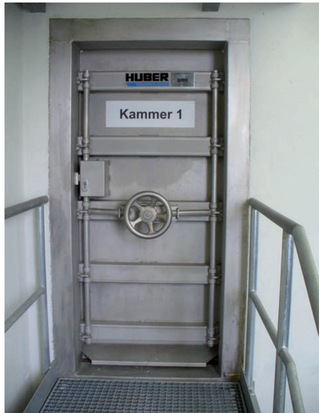
Drucktür, rechteckig, mit bedienerfreundlichem Zentralverschluss, Typ TT 7.Z
