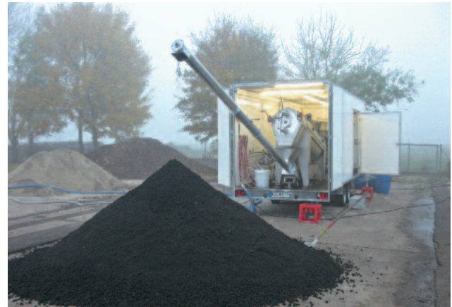
Konttin asennettu RoS 3Q 440 laite sopimuskuivaukseen
